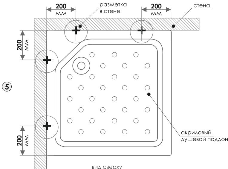
6. Уберите поддон в сторону и по нанесенной разметке установите крепежные кронштейны на стенах:
