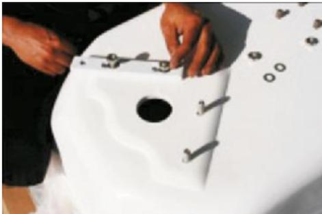
3. Приложите декоративную опору к ванне так, чтобы зазоры между ней и ванной были минимальны, а отверстие в опоре совпало с отверстием в монтажной планке. Зафиксируйте опоры болтами, входящими в комплект. Протяните все гайки при помощи регулируемых опор. Поставте ванну по уровню.
