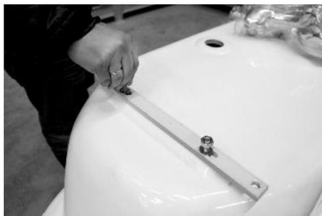
**3.** Приложите декоративную опору к ванне так, чтобы зазоры между ней и ванной были минимальны, а отверстие в опоре совпало с отверстием в монтажной планке. Зафиксируйте опоры болтами, входящими в комплект. Протяните все гайки при помощи регулируемых опор. Поставьте ванну по уровню.
